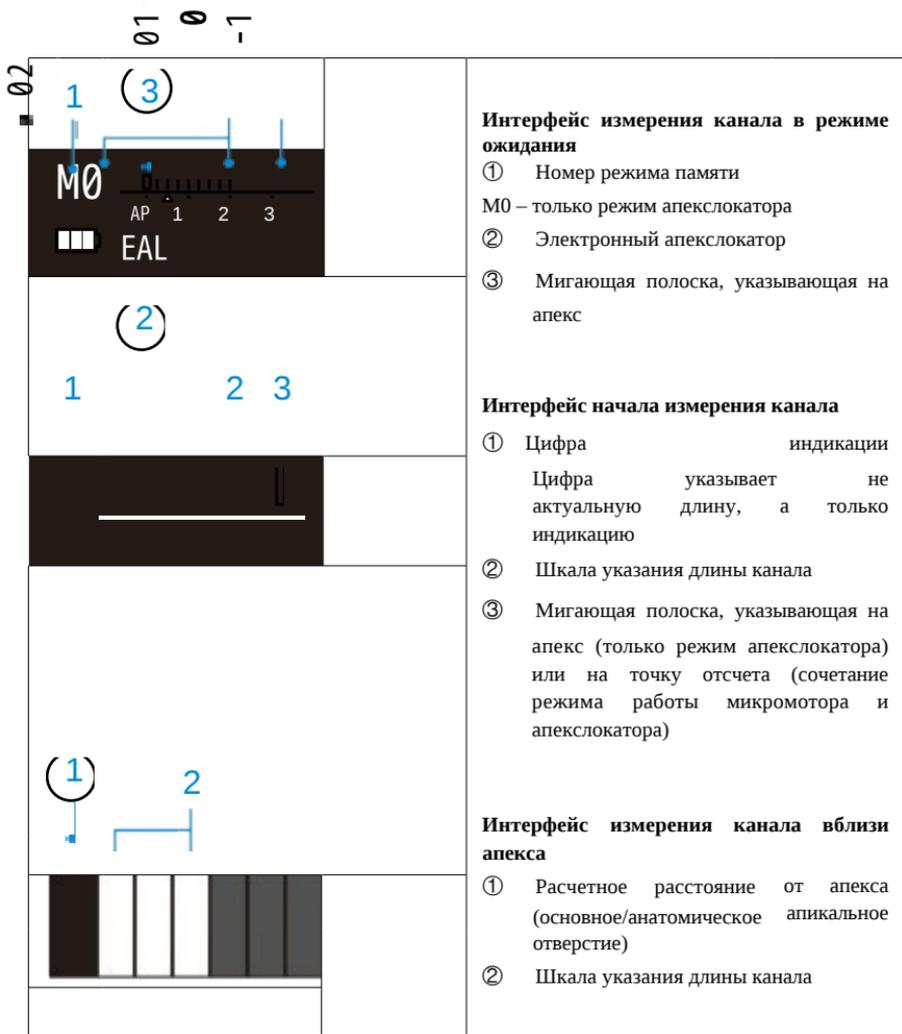
**Интерфейс измерения канала в режиме ожидания**
